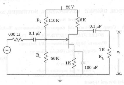
$$g_{\rm m}=2.5~{\rm mS},\,r_{\rm d}=200~k\Omega,\,{\rm C_{gs}}=12~{\rm pF},\,{\rm C_{gd}}=2{\rm pF}~{\rm R_1/\!/R_2}=0.1~{\rm M},\,{\rm C_W}+{\rm C_L}=10~{\rm pF}$$
